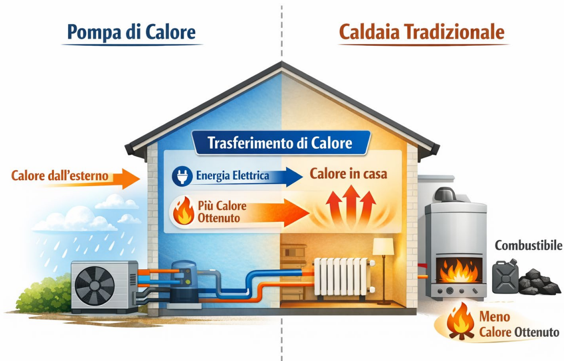
Figura 17 – Pompa di calore vs Caldaia
