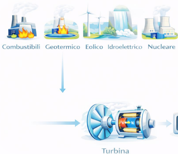
Figura 5 – Il principio comune delle centrali
